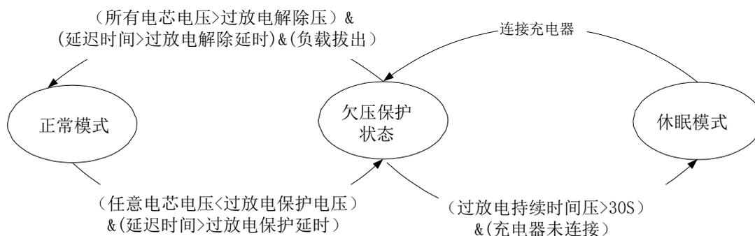
图 4 过放电保护状态转移图
