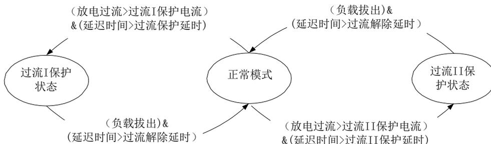
图 5 过流保护状态转移图
