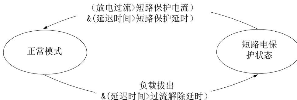
图 6 短路保护状态转移图
