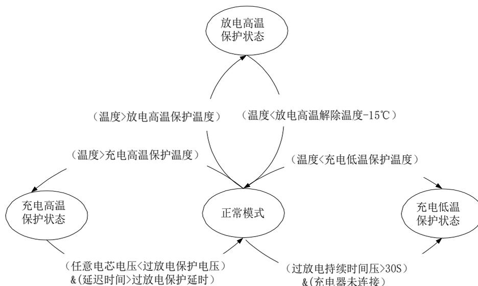
图 7 温度保护状态转移图
