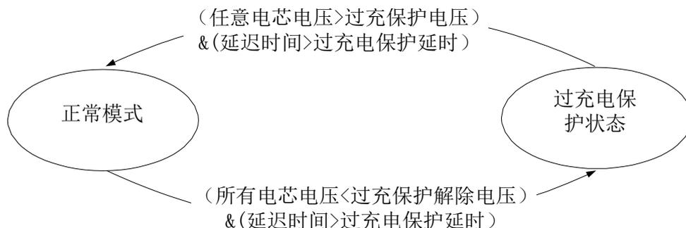
图 3 过充电保护状态转移图
